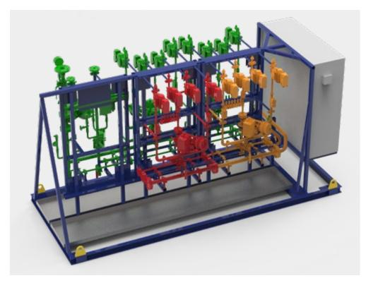
Unabhängig von der gewählten Lanzenanzahl sind Grundrahmen, Eintrittsmodul und Schaltschrank immer gleich aufgebaut. Jedes der identisch aufgebauten Eindüsmodule versorgt zwei Lanzen. Abhängig von der gewählten Lanzenanzahl werden die erforderlichen Eindüsmodule implementiert. Durch den modularen Aufbau können bei zukünftigen Änderungen der Grenzwerte weitere Eindüs-
