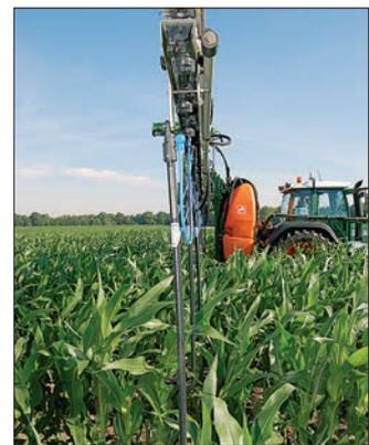
2,25 m Spurweite und bietet 1,20 m Bodenfreiheit, so dass späte Unkrautbekämpfungsmaßnahmen problemlos im Mais durchgeführt werden können.
