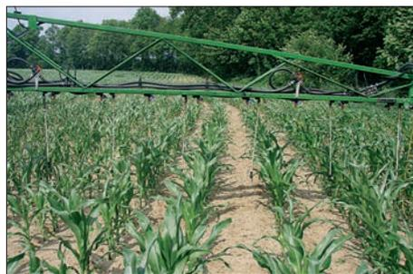
Die elastischen Agrotop-Schlepprohre sind mit Spiralfedergelenken bruchsicher aufgehängt.
