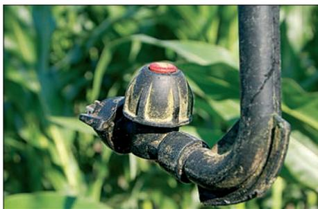
Am Fuße des Droplegs ist eine FT-Zungendüse auf dem Düsenträger mit Membranrückschlagventil montiert.
