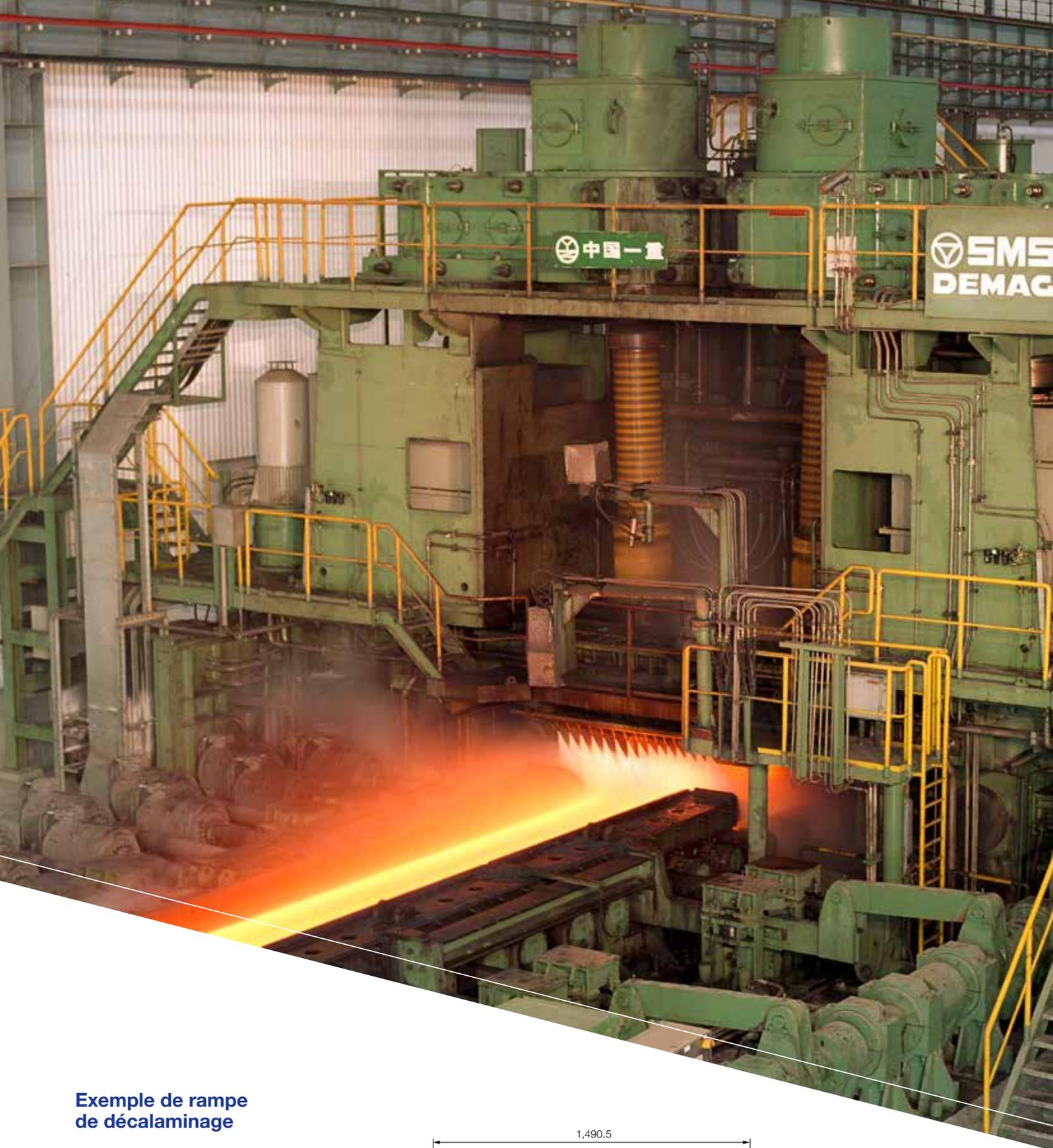
**Exemple de rampe de décalaminage**
