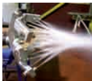
Rampe d'atomisation avec buses bi-fluides type SlabCooler pour cellule de trempe
