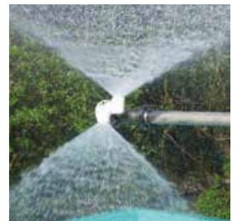
Sprühbild mit zwei Hohlkegeln mit gegenläufiger Drallrichtung
