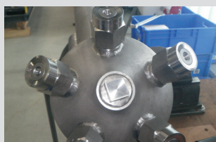
Bündelköpfe mit 5 bzw. 6 Düsen Betrieb bei 35 bar
