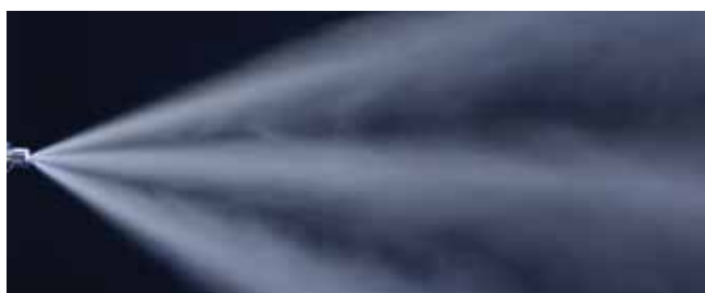
Patrón de aspersión de la boquilla de aspersión plana
