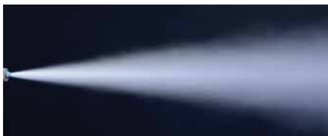
Patrón de aspersión de una boquilla Laval
