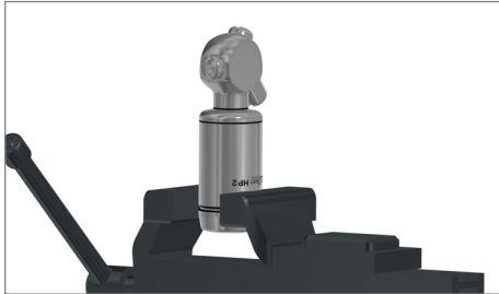
Spannung zum Lösen der zweiten Gewindeverbindung
